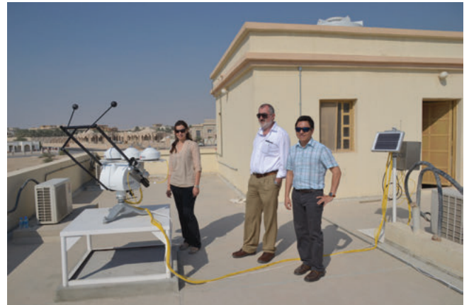
Figura 1: Daniel Perez, Mokhtar Chmeissani, i Dunia Bac-hour amb el primer sistema de seguiment solar, el SOLYS 2, instal·lat a Qatar per a mesurar la irradiància solar.
